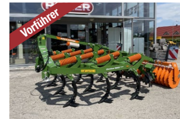
Amazona Genius 3003 Super (300 cm) Bj 2023 11 Stück Zinken, 80 mm C-Mix Hartmetallschare, Disc Walze DW 600 mm, Abstreifer, Beleuchtung, ... Preis inkl. 20 % MWSt. EUR 29.040,-
