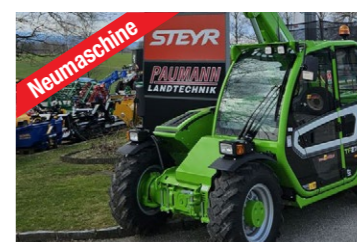
Merlo Teleskopklader TF 27.6 (75 PS) Bj 2024 6 m Hubhöhe, inkl. Merlo Stapelgabel, 2.700 kg Tragkraft, 95 l/min Hydraulik, Stage V mit DOC und DPf, 40 km/h, ... Preis auf Anfrage
