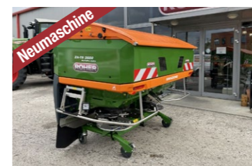
Amazona ZA-TS 2600 ProfisPro Tronic Bj 2023 2.600 l, Wiegezellenstreuer mit ISOBUS, mech. Antrieb, Zweischiebenstreuer, Grenzstreueinrichtung, ... Preis auf Anfrage
