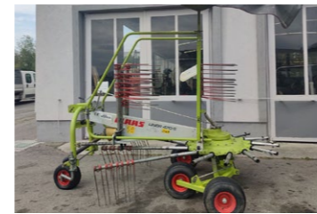
Claas LINER 470 S (470 cm) Bj 2008 Tandemfahrwerk, 13 abnehmbare Arme, Gelenkwelle, Tastrad, Schwenkbock, Nachlaufeinrichtung, Seitenschwad Preis auf Anfrage
